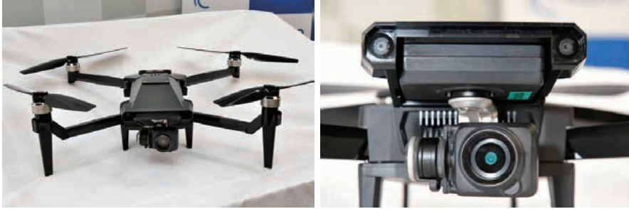
図15 NEDO プロジェクトで開発したドローン（左）、機首に搭載された衝突回避機能のためのステレオカメラとその下面のジンバルカメラ（右）〔出典：参考文献17〕
