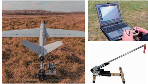
図8 徘徊型ドローン Warmate の外観(左)とコントローラ・表示装置・射出装置(右)(出典：WB Group Warmate カタログ 6) )
