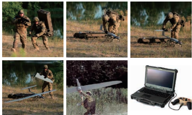
図9 監視ドローン FlyEye の組み立て状況とコントローラ・表示装置(出典：WB Group FlyEye カタログ 7) )
