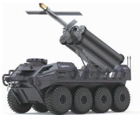
図10 徘徊型ドローン Warmate TL のミッション・マスター無人地上車両への搭載構想図（出典：Rheinmetall）
