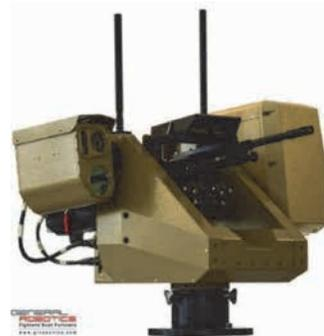
図13 Pitbull-3対ドローン・リモートコントロール武器ステーション (出典: 参考文献11))
